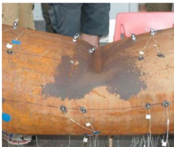
Figura 5. Ensayo de perfil tubular a flexión para obtener la deformación límite de abolladura [5].
