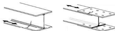
Figura 2. Unión soldada (izquierda) y unión mecánica (derecha) [2]
