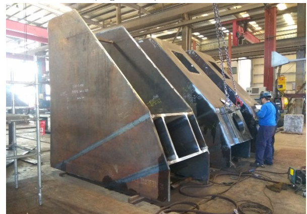
Figura 15. Secuencia de fabricación del diafragma de anclaje del tirante.
