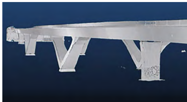
Figura 24. Modelo geométrico 3D del puente existente.
