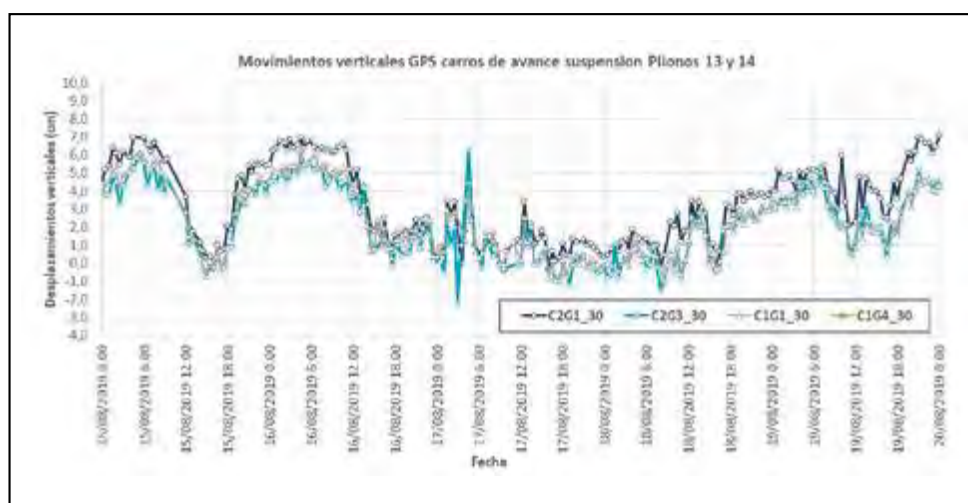
Figura 56. Diferencias de elevación en GPS antes durante y después de vaciado de dovela de cierre.
