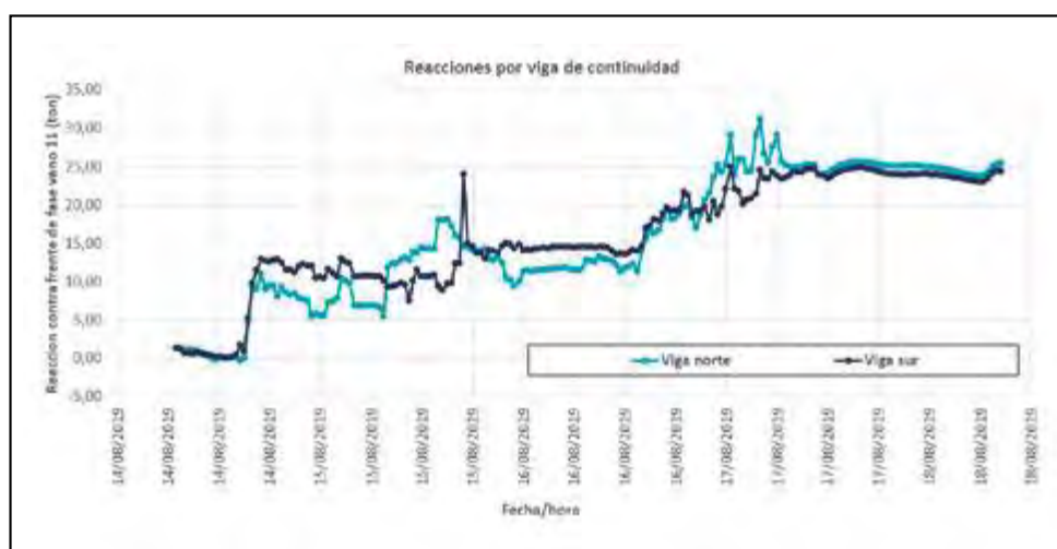
Figura 54. Reacciones en vigas de continuidad para el cierre del vano principal.
