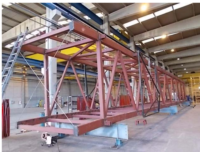
Figuras 9a y 9b. Dimensiones de la estructura metálica básica y cuba de galvanizado más grande existente en España (2.50m x 4.00m x 16.00m)
