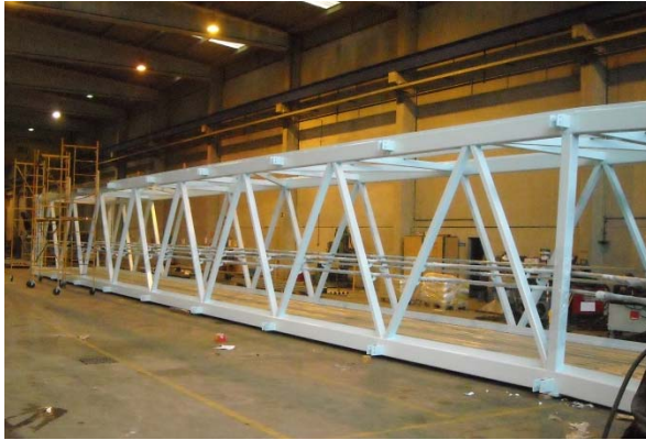
Figuras 10a y 10b. Detalle del sistema de protección anticorrosiva de la estructura metálica mediante pintura
