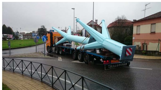
Figuras 12a y 12b. Transporte a obra en camión de las estructuras metálicas
