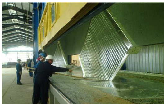
Figura 8. Galvanizado en caliente de una pieza introduciéndola en el crisol de zinc
