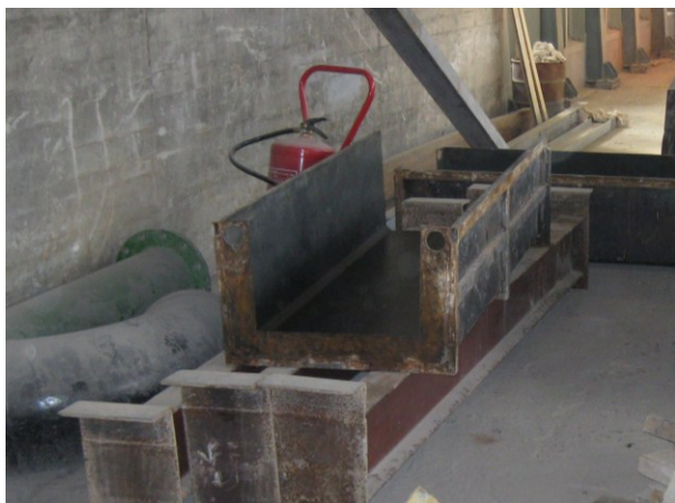
Figura 19. Detalle de encofrado metálico.
