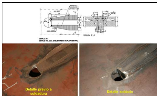
Figura 9. Extremo de alma central en nudos, con ojal en el extremo y transiciones de soldaduras.
