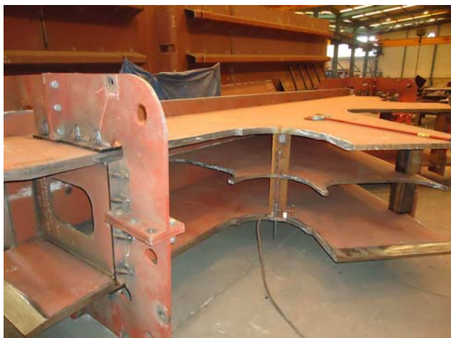
Figura 12. Vista de un nudo tumbado con el útil de izado y volteo en su extremo.
