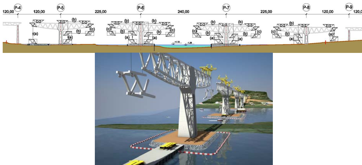
Figura 14. Secuencia del proceso de izado de los vanos laterales 10, 11 y 12.
