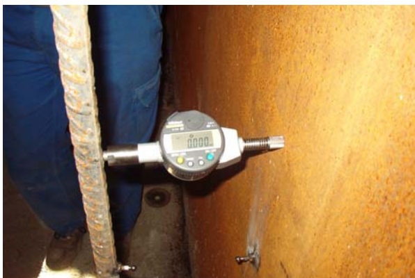
Figura 33. Control deformaciones transversales en el alma
