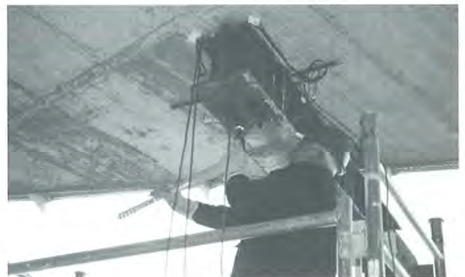
Figura 15. Ensayo de calibración de las uniones pretensadas, instrumentalizando los T.A.R.
