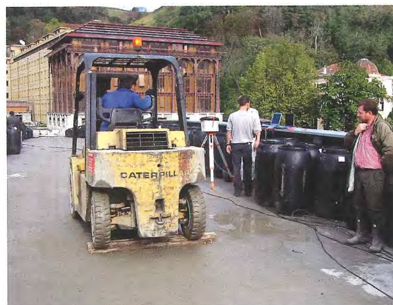
Photos 24 : Essais dynamiques - a) petit groupe synchronisé, b) impulsion mécanique / Dynamic tests - a) synchronized small group, b) mechanical impulse
