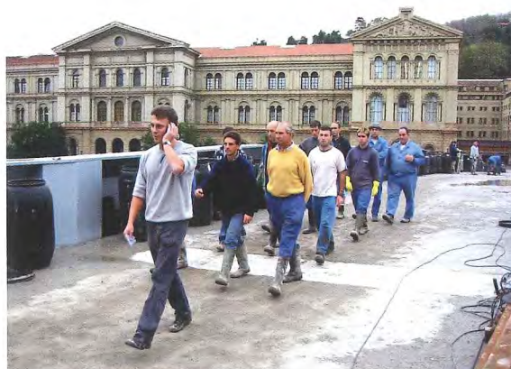
Photos 24 : Essais dynamiques - a) petit groupe synchronisé, b) impulsion mécanique / Dynamic tests - a) synchronized small group, b) mechanical impulse
