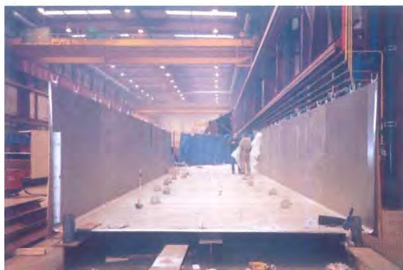
Photo 9 : Fabrication par segments / Stainless steel segments
