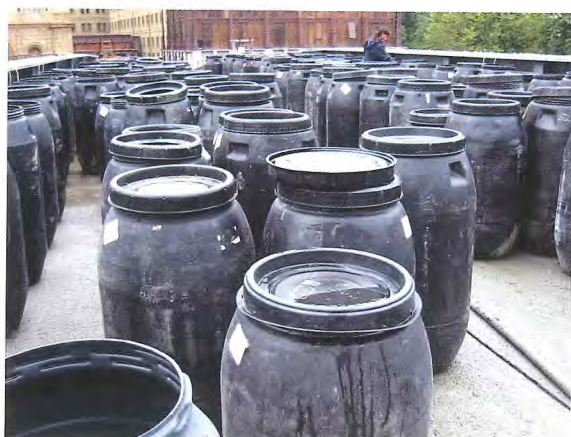
Photo 23 c : Essais statiques - Bidons d'eau / Static tests - Water filled cans
