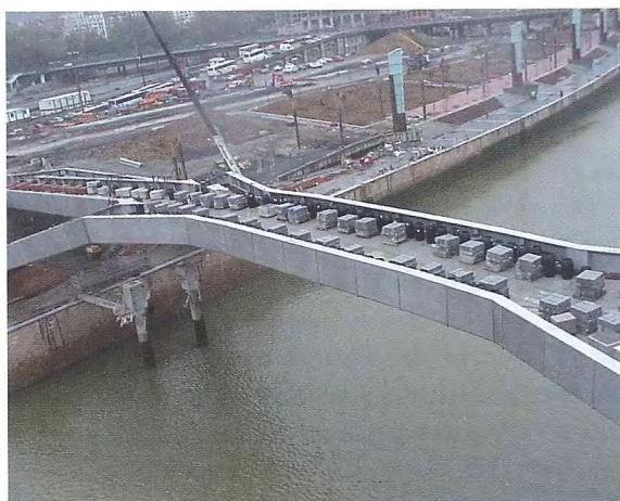
Photos 23 : Essais statiques - a) tablier central, b) rampes / Static tests - a) central deck, b) ramps
