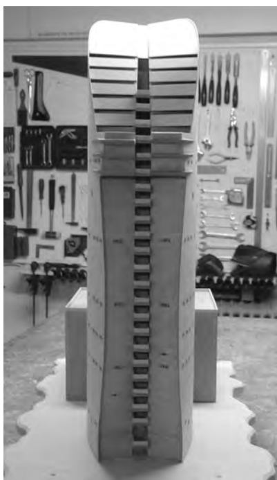
Figuras 18, 19, y 20. Vista frontal, lateral y trasera de la maqueta realizada del Hotel Vela para el ensayo del túnel de viento (1).
