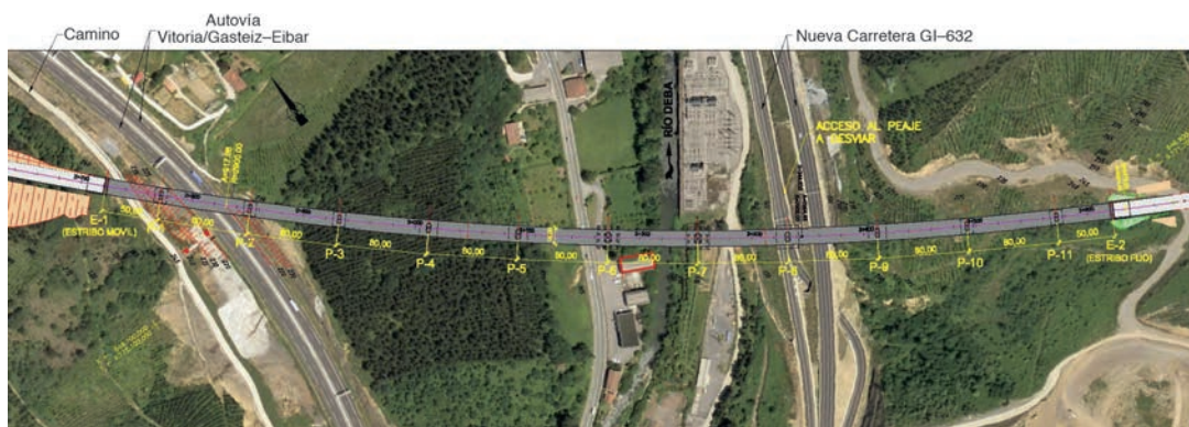
Figura 9. Planta de la solución mixta desarrollada en el proyecto original que proyecta el viaducto en el entorno.
